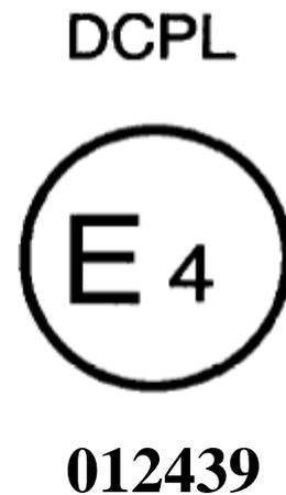
Le projecteur portant la marque d'homologation ci-dessus est un projecteur qui répond aux exigences du présent Règlement, tel que modifié par la série 01 d'amendements. Muni d'une source lumineuse à décharge pour le faisceau de croisement uniquement et d'une lentille en matériau plastique, il est conçu :
