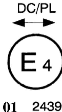
Identification d'un projecteur à faisceau de croisement répondant aux exigences du présent Règlement, tel que modifié par la série 01 d'amendements, et comportant une lentille en matériau plastique,
